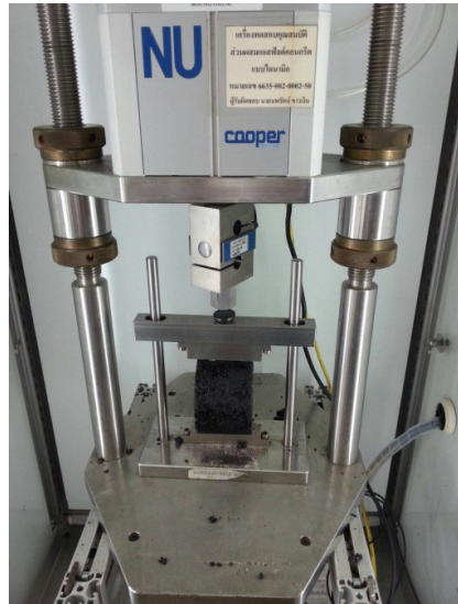
ภาพที่ 11 การทดสอบหาความล้าเนื่องจากแรงดึงทางอ้อม
