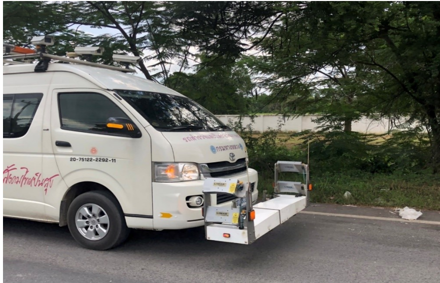
ภาพที่ 15 รถสำรวจสภาพทาง
